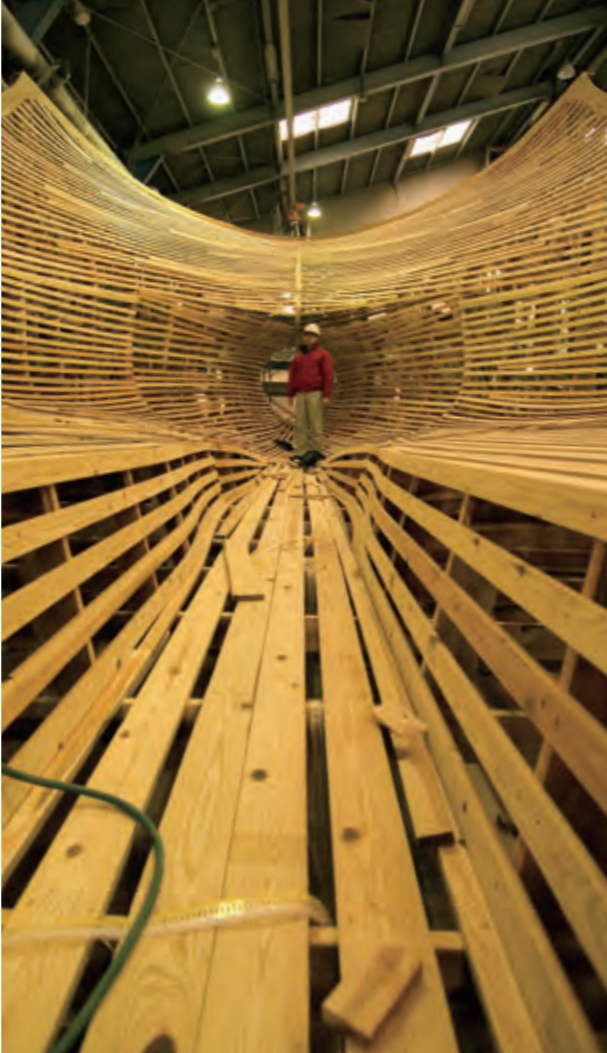
底曳網漁船などの大型船造りは木型職人による成形から始まる
